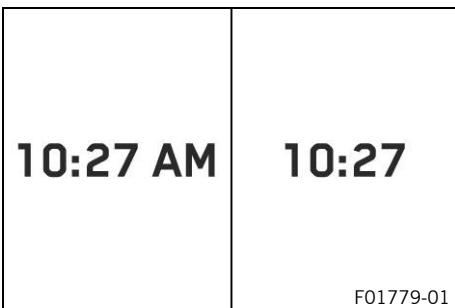
En todos los idiomas, excepto en EN-US, se muestra la hora con el formato de 24 horas. La hora se muestra en formato de 12 horas si está configurado el idioma EN-US. En el submenú **Clock/Date** puede configurarse la hora.
